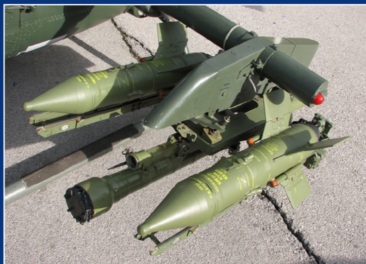
Naoružanje Game: protivoklopne vođene rakete Maljutka i rakete vazduh-vazduh Strela-2M foto: A. Radić
