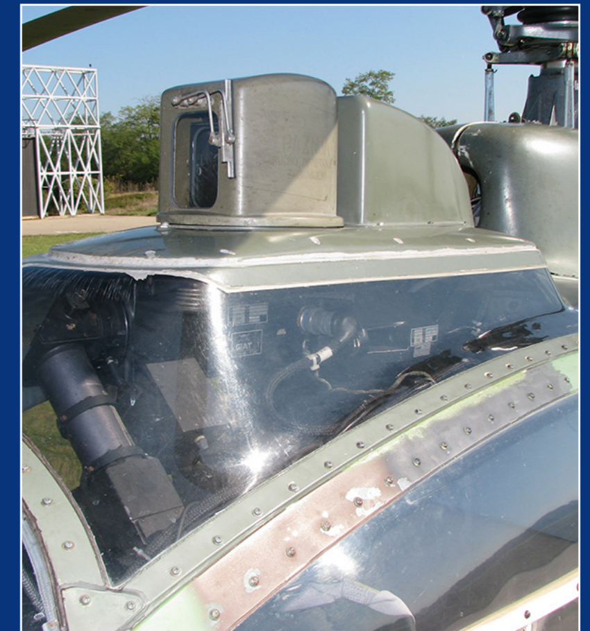
Na Heri nišanski sistem APX M334.25 koristi se kao uređaj za osmatranje i korekturu artiljerijske vatre foto: A. Radić
