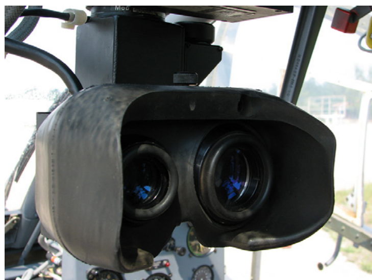
Durbin nišanskog sistema APX M334-20 kroz koji teren osmatra operater Maljutki foto: A. Radić
