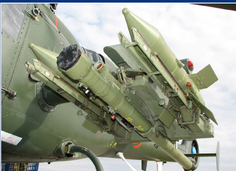
Naoružanje Game: protivoklopne vođene rakete Maljutka i rakete vazduh-vazduh Strela-2M foto: A. Radić
