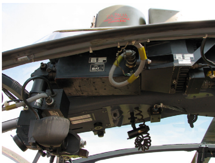
Pogled na nišanski sistem APX M334-20 na krovu kabine Gazele foto: A. Radić
