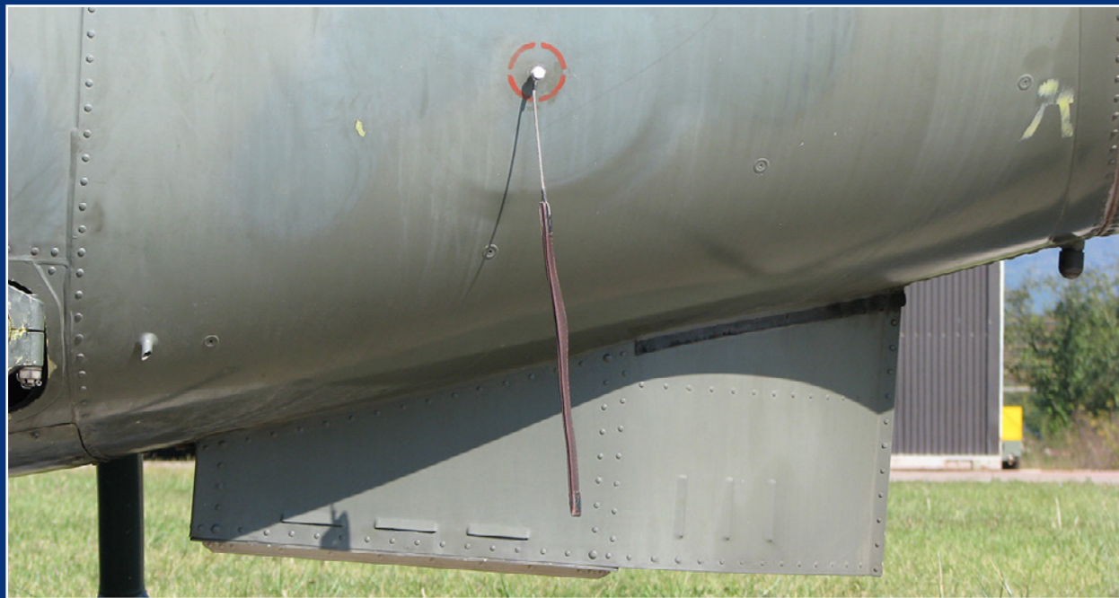
Kučište navigacionog uređaja Decca Doppler 80. foto: A. Radić
