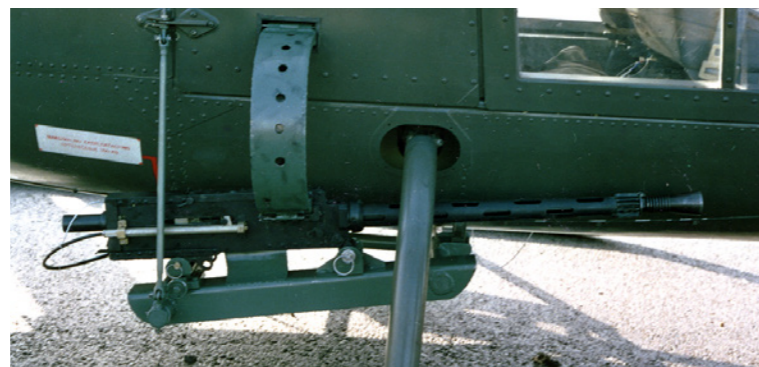
Mitraljez MK II 7,7 mm postavljen na bok Game HN-45 foto: VOC
